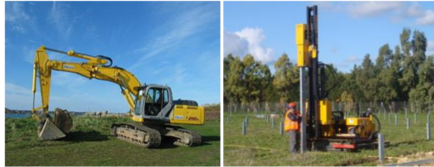
Figure 38 : Exemple d'une pelleuseuse et d'une batteuse de pieux
