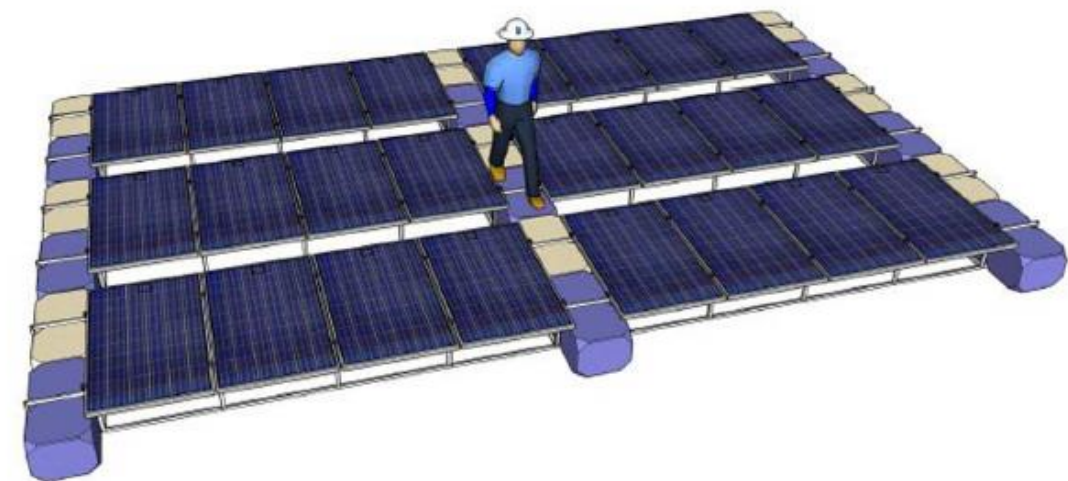
Figure 25 : Exemple de structure pontons (source : NRG)
