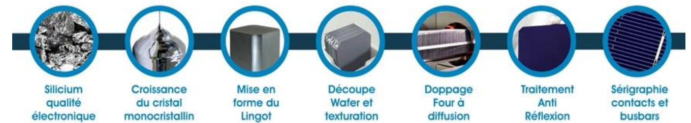
Figure 22 : Procédés de fabrication d'une cellule cristalline semi-conductrice de silicium (Jade Technologie)
